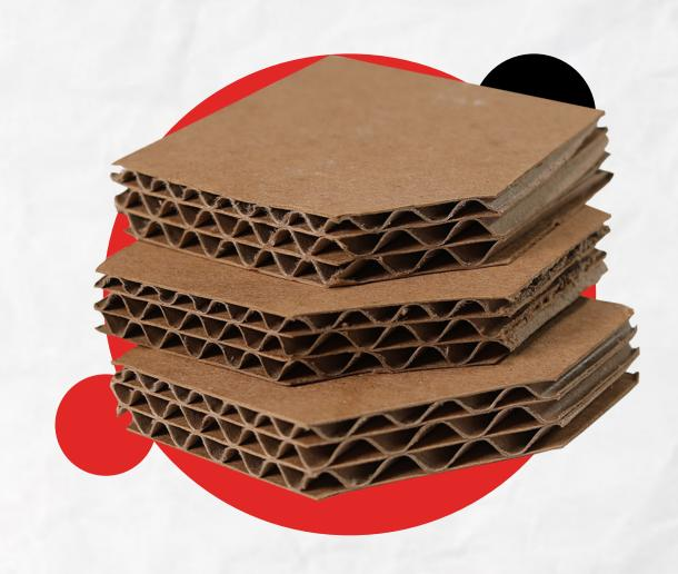
IF THE BOX IS HIT FROM THE OUTSIDE, THE FORCE OF THE BLOW WILL BE PARTIALLY **ABSORBED BY THE CORRUGATED LAYERS AND** THEIR AIR CHANNELS.
