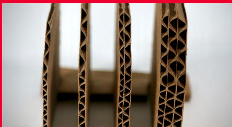
**Mullen:** Esta prueba mide la resistencia al estallamiento o a la perforación de un empaque corrugado y se expresa en kilogramos por centímetro cuadrado o en libras por pulgada cuadrada. El papel compacto (linerboard) es
